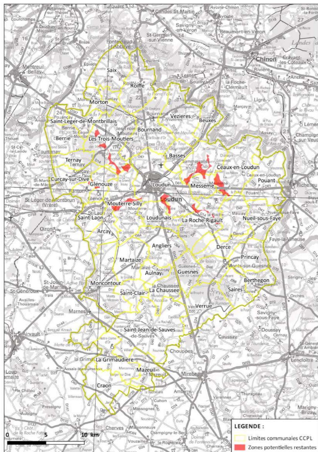
Carte 99 : Zones potentielles d'implantation restantes au regard d'une distance de 600 m aux habitations, d'un niveau topographique supérieur à 70 m NGF, hors servitudes et contraintes techniques (aéronautiques, radar), en appliquant une distance d'éloignement par rapport aux éléments structurants (routes, lignes HT, gazoducs), hors zones naturelles protégées et périmètres paysagers et hors petites zones isolées
